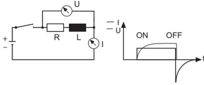
**Conmutación de la bobina de un relé**
