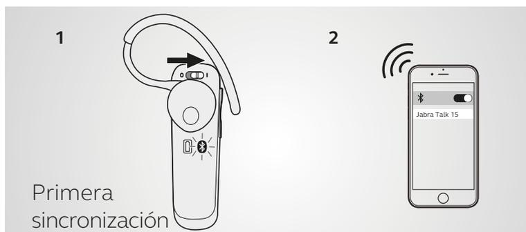
1. Deslice el interruptor Encendido/Apagado a la posición Encendido. El LED de Bluetooth parpadeará en azul.
