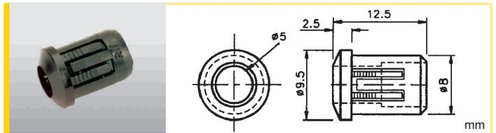
**RTF-5010** LED:  $\varnothing 5\text{mm}$  Taladro / Hole:  $\varnothing 8\text{mm}$
