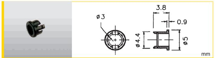
**RTC-31** LED:  $\varnothing 3\text{mm}$  Taladro / Hole:  $\varnothing 4,5\text{mm}$
