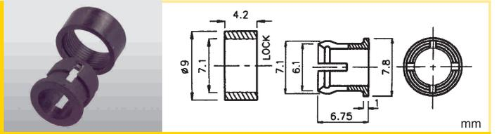
**CB-50** LED:  $\varnothing 5\text{mm}$  Taladro / Hole:  $\varnothing 6,5\text{mm}$
