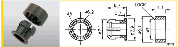
**RTC-52** LED:  $\varnothing 5\text{mm}$  Taladro / Hole:  $\varnothing 6,5\text{mm}$
