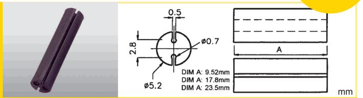
**BR-A** LED:  $\varnothing 5\text{mm}$  Taladro / Hole:  $\varnothing 5\text{mm}$
